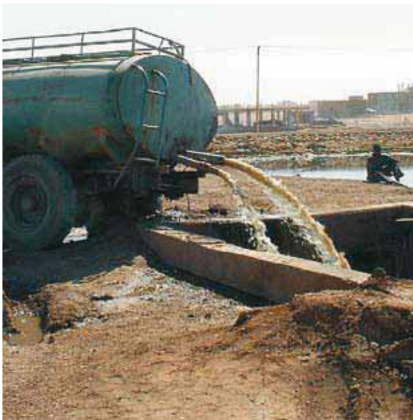
**FIGURE 28:** Vidange d'un camion rempli d'eaux usées dans la station d'épuration de Khartoum.
